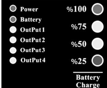
**Power:** این LED در صورت وصل برق شهری روشن و در غیر این صورت خاموش می باشد.
